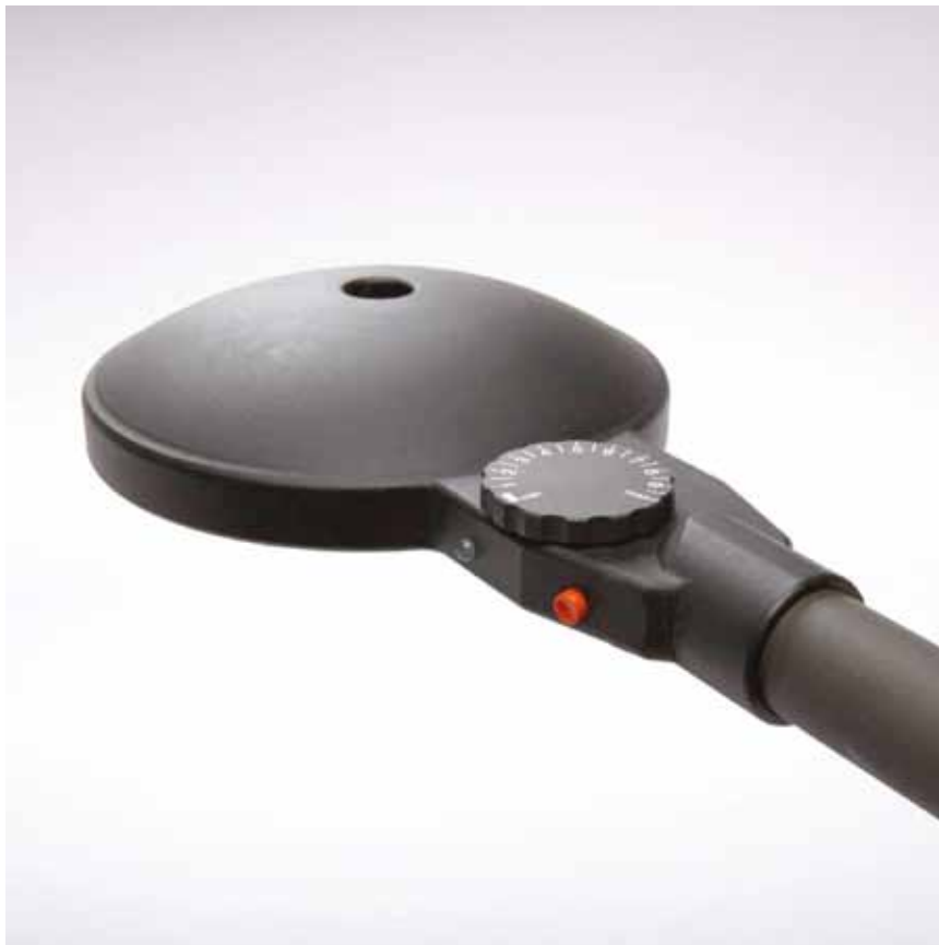
Slika 1. Zavojnica za transkranijalnu magnetnu stimulaciju [Izvor: https://bioelektronika.hr/magventure/mmc-140-1/ ]
